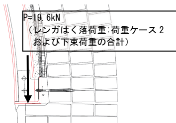
Fig. 7 根足部レンガに作用する荷重
