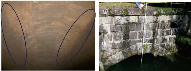
Photo. 1 水位痕 (15.7m<sup>3</sup>/s) Photo. 2 水位計測 (10.4m<sup>3</sup>/s)
