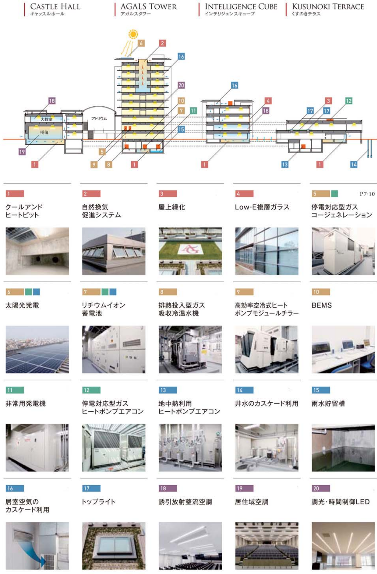
Fig.1 MKCで採用された省エネルギー手法
