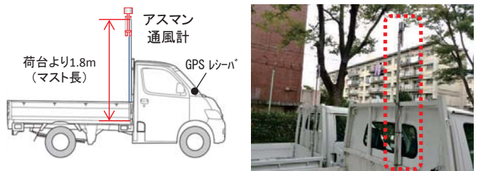
Fig.6 巡回計測車 (左: 全景, 右: アスマン取付状況)
