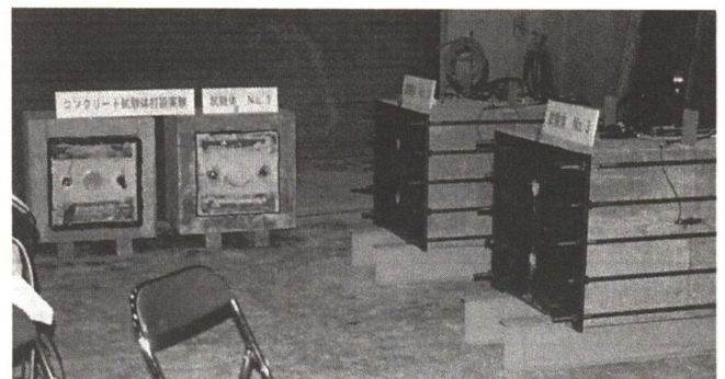
Photo.2 継目面を解体したコンクリート試験体と充填前の試験体
