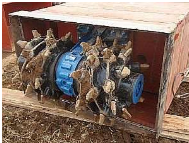
ツインヘッダーの取り付け状況
