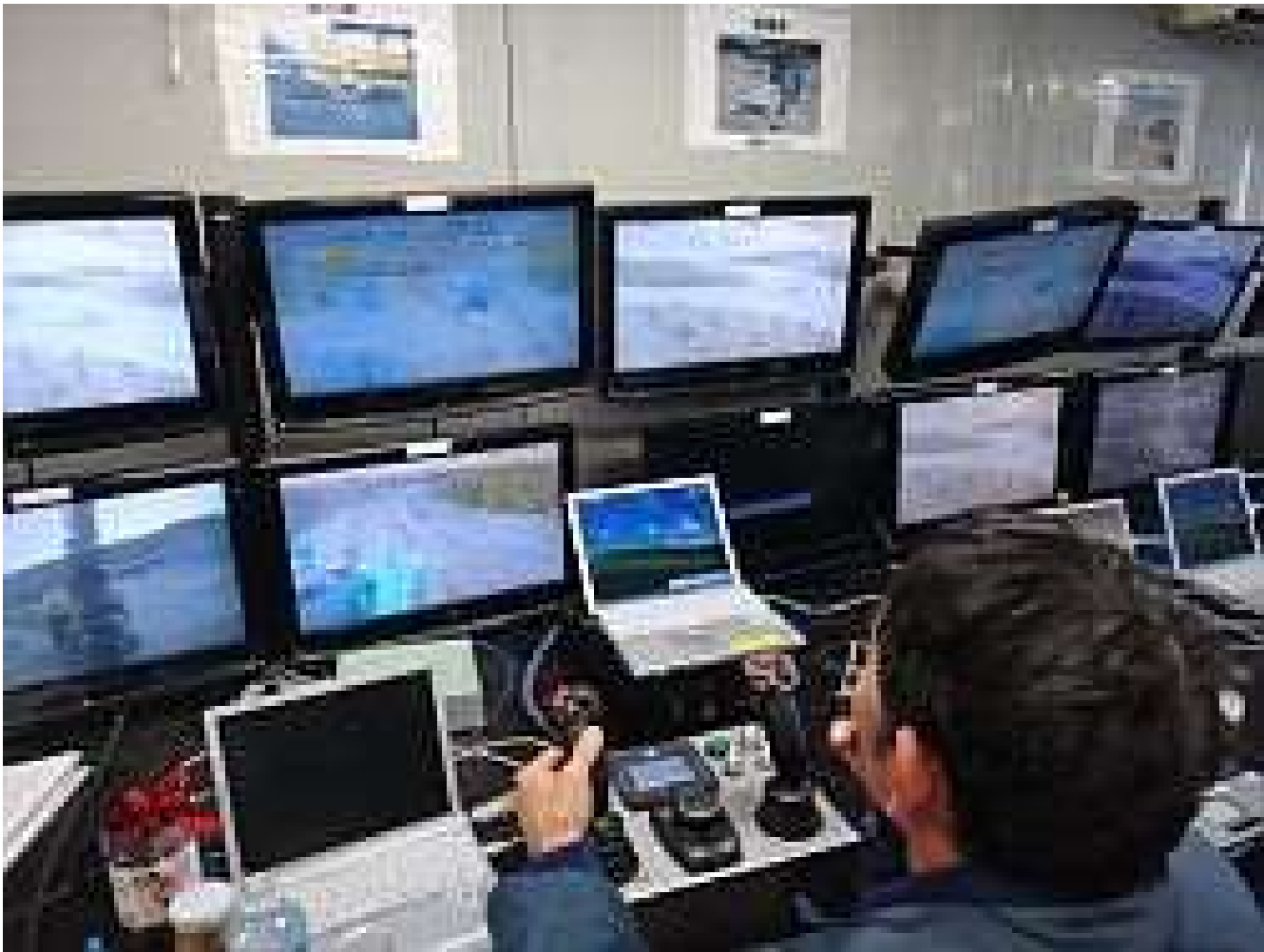
無人化施工操作室
