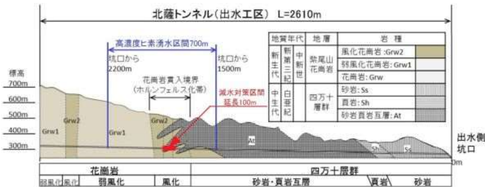
図 2 地質縦断面図
