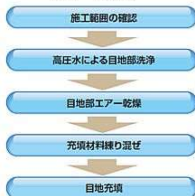
図-1 施工フロー
