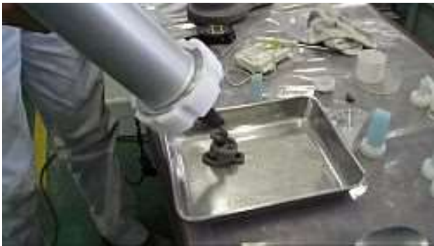
写真5 注入ガンからの吐出状況
