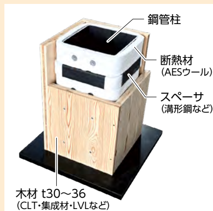
「ドレスウッド®」柱1.5時間耐火の構成
