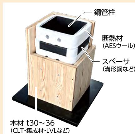
「ドレスウッド®」柱1.5時間耐火の構成
