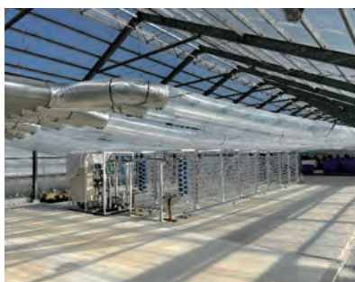
藻類培養装置(フォトバイオリアクター)
