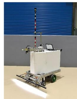
ひび割れ自動計測ロボット
