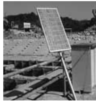
機械による自動測定も実施し、電子データとして遠隔管理しています。なお、この測定機は太陽電池により作動しています。
