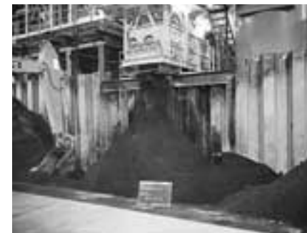
改良された建設汚泥
