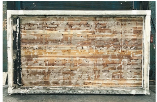
試験後の試験体(燃え止まり層をはがした後の荷重支持部材(CLT)の状態)
