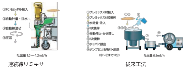
Fig.2 連続練りミキサを用いたモルタル吹付け工法と従来工法の比較
