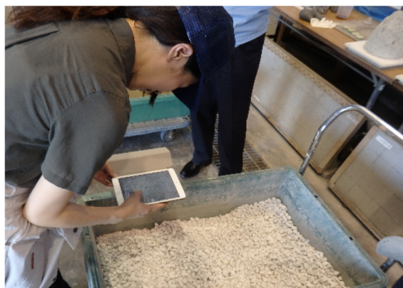
Photo. 2 一般コンクリート骨材の判別画像の撮影状況
