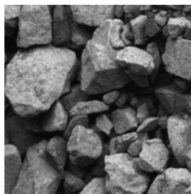
Photo. 1 粒径の小さい骨材が多く写る誤判定画像の一例
