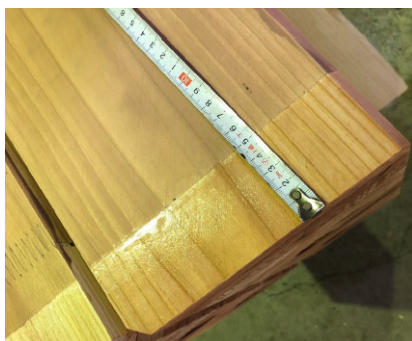
Photo. 3 干割れ防止剤塗布状況
