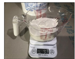
Photo. 21 塗布量管理用のくし、重量確認状況
