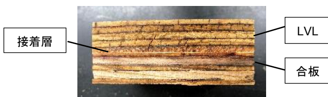
Photo. 3 減圧加圧剥離試験後写真
