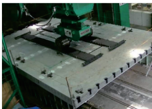
Photo. 8 輪荷重走行試験
