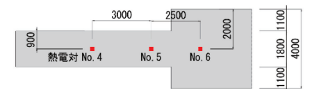
Fig. 21 リフト6 温度計測位置
