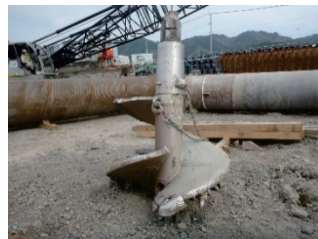
Photo. 12 先行削孔用ビット
