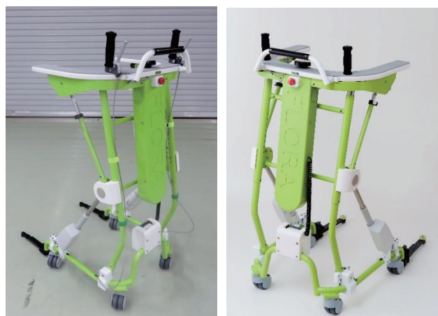
Photo. 4 試作2号機（ブレーキあり（左）となし（右））
