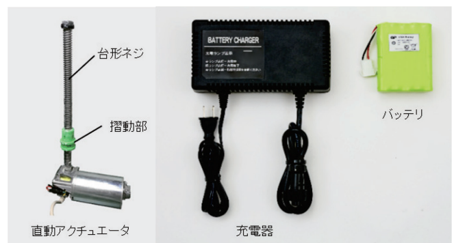
Photo. 5 直動アクチュエータとバッテリー，充電器
