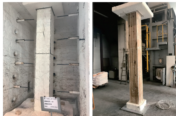
Photo. 1 柱の性能評価試験後の様子
