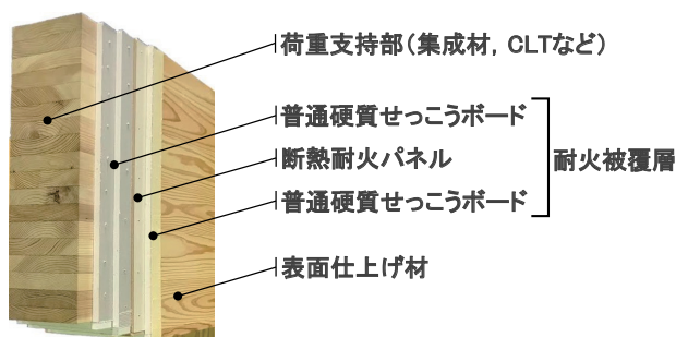
Fig. 1 「断熱耐火 λ-WOOD®」の概略図
