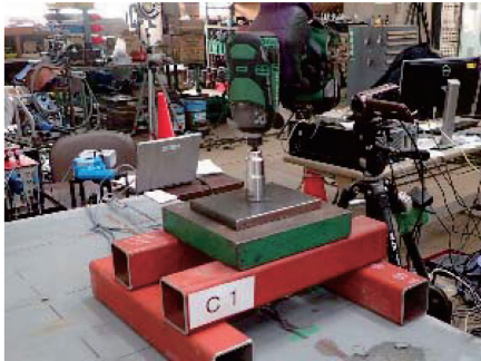
Photo. 8 インパクトレンチによる動的締付け実験状況
