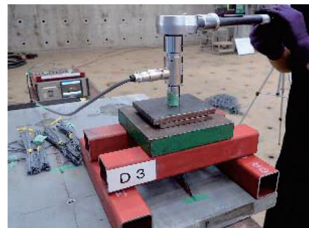
Photo. 7 ラチェットによる静的締付け実験状況
