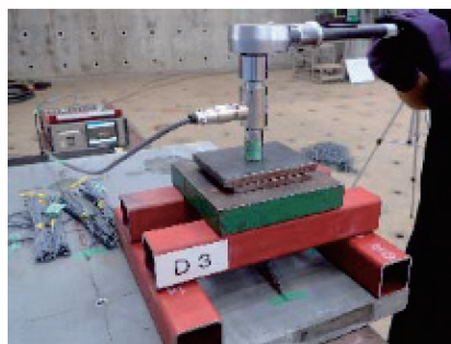
Photo. 2 ラチェットによる 静的締付け実験状況
