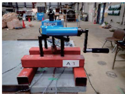
Photo. 1 引張試験器による 静的な引抜き実験状況
