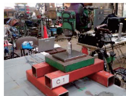
Photo. 3 インパクトレンチによる 動的締付け実験状況
