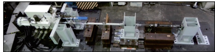
Fig. 3 複合ダンパー基本特性試験 実験状況
