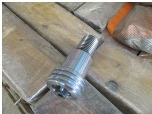
写真-5 セグメント固定金物（押し後）
