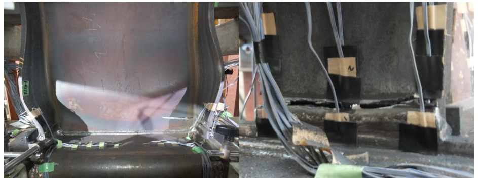
(3)H-R (4)H-N (b) 終局時における破断状況
