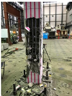
Photo. 3 DB-1D 試験体のコンクリート剥離の様子
