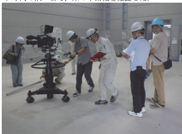
Photo. 6.8 スタジオドリー走行検査状況
