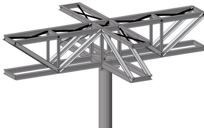
Fig.2 メイントラスー柱接合部詳細図 (A部)
