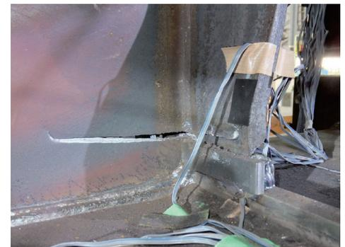
(b) 梁フランジ溶接部からの亀裂 (No. 2)
