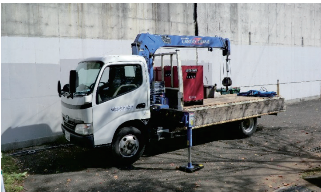
Photo. 11 200V 発電機とユニック車
