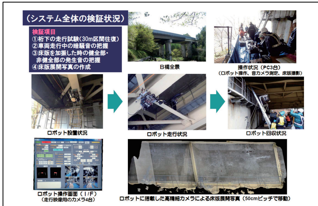
Fig.2 実橋梁での検証項目
