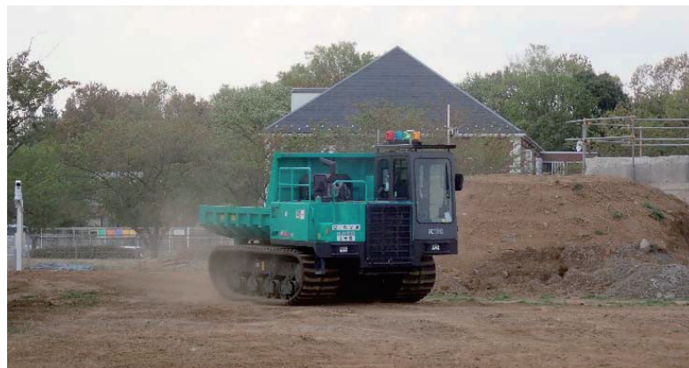
Photo.5 無人化施工機械走行試験状況
