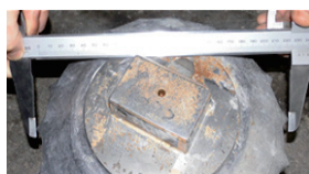
写真-2 ゲージカッター摩耗状況
