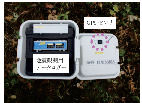
Photo. 2 データロガー内蔵計測ボックス
