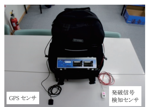
Photo. 4 起振点側 (坑内) の測定機器
