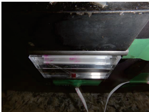
Photo. 10 センサーの状況 (130mm, 載荷終了後)
