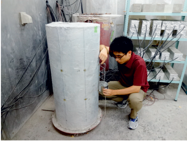
写真3 コンタクトゲージによる鉛直ひずみの測定
