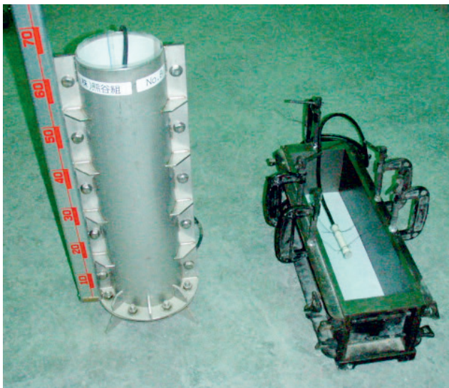
写真-2 150×150×530mmの角柱供試体用型枠とφ150×530mmの円柱供試体用型枠
