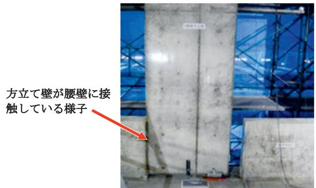
方立て壁が腰壁に接触している様子
