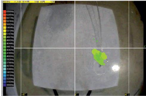
Fig. 23 うき部を加振したときの表示画面 (3,000~6,500Hz, 65dB以上)
