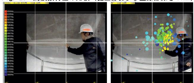
Fig. 27 うき部の実験結果(左:健全部, 右:うき部) (3,000~6,500Hz, 50dB以上)
