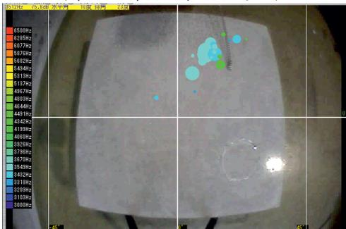
Fig. 24 空隙部を加振したときの表示画面 (3,000~6,500Hz, 65dB以上)
