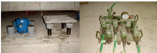
Photo. 8 (左) 油圧ジャッキと鋼製サンドル (上・右) 油圧ポンプユニット
