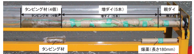
Photo. 4 模擬の爆薬による遠隔装填システムによる密装填状況
