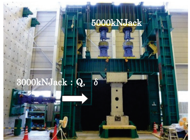
Photo.1 荷重装置全景
