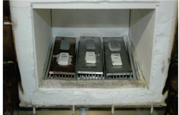
Photo. 2 接着性確認試験(小型マッフル炉による昇温試験)
