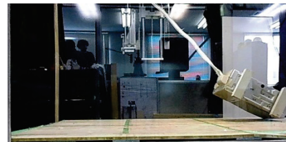
Photo. 2 室外機の風による挙動(風向0度; 正面)
