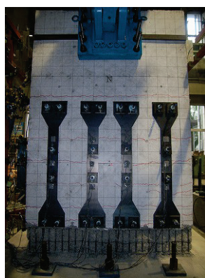
No. 3 供試体の損傷状況 (10 \delta y 載荷終了時)
