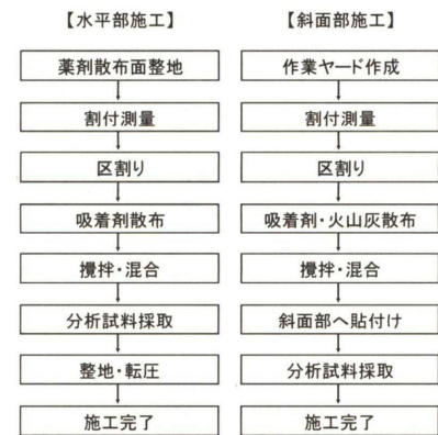
Fig. 6 吸着層 安定処理施工フロー
