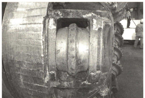
Photo.2 ゲージカッタ磨耗
