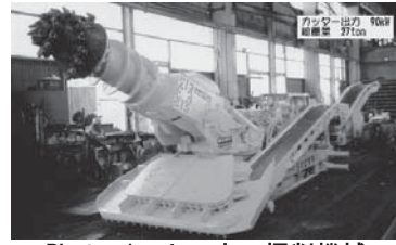
Photo. 1 トンネル掘削機械 (ミゼットマイナー90kW 級)
