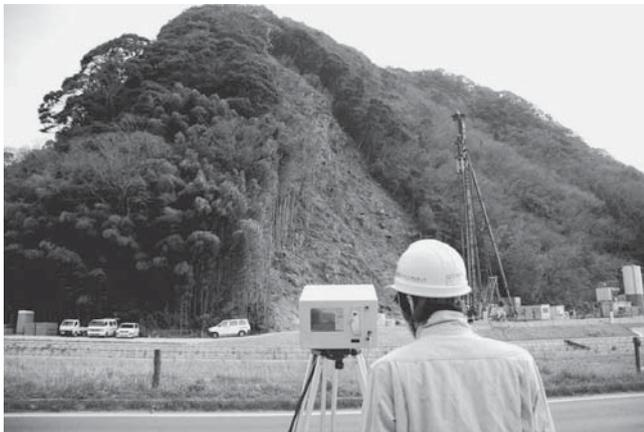
Photo. 4 3Dレーザ計測状況
