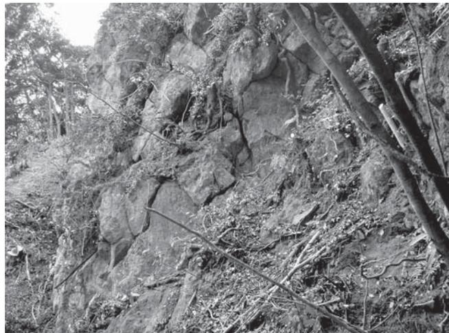
Photo.2 開口亀裂を伴う岩盤の状況
