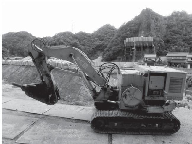
Photo. 5 高所岩盤掘削機
